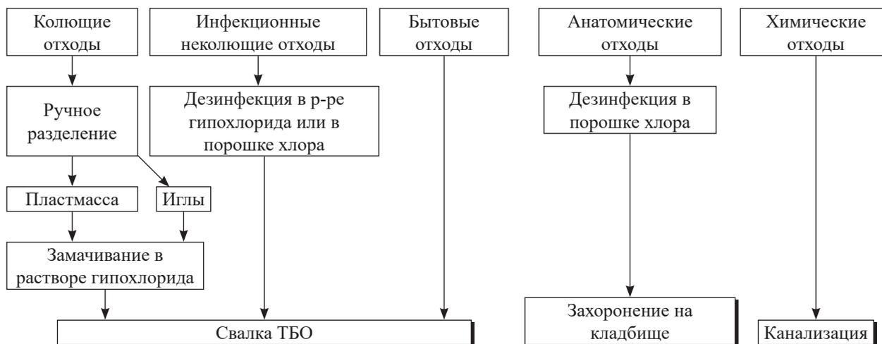
Рис. 3. Схема организации системы УМО в больницах КР до внедрения эффективной системы УМО
