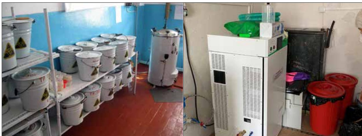
Рис. 3. Автоклав ВК-75 и микроволновая печь в пунктах обеззараживания МО в ОЗ КР
