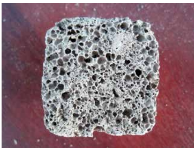
Глинистый грунт с воздушными порами.
