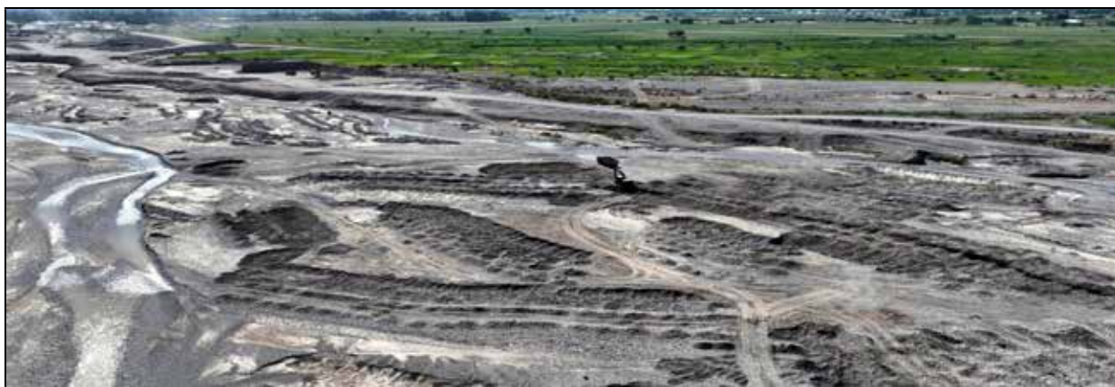
Рис.3. Снимок с БПЛА, характеризующий изменение русла в результате интенсивного забора ПГС на русле р. Кугарт.
