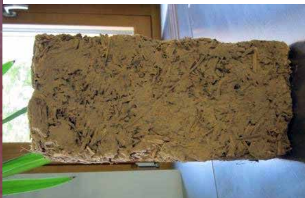
Глинистый грунт с соломенной фиброй.
