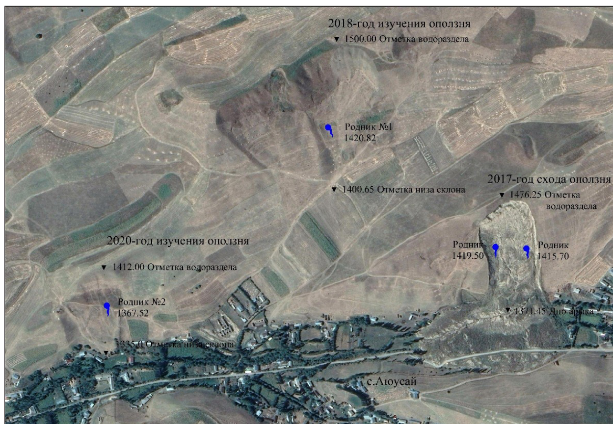
Рис. 4. Схема расположения родников на оползнях
